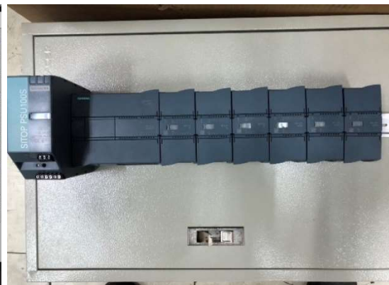
รูปที่ ๓ โปรแกรม TIA PORTAL (ซ้าย) Module ของ PLC ตรายี่ห้อ SIEMENS (ขวา)
