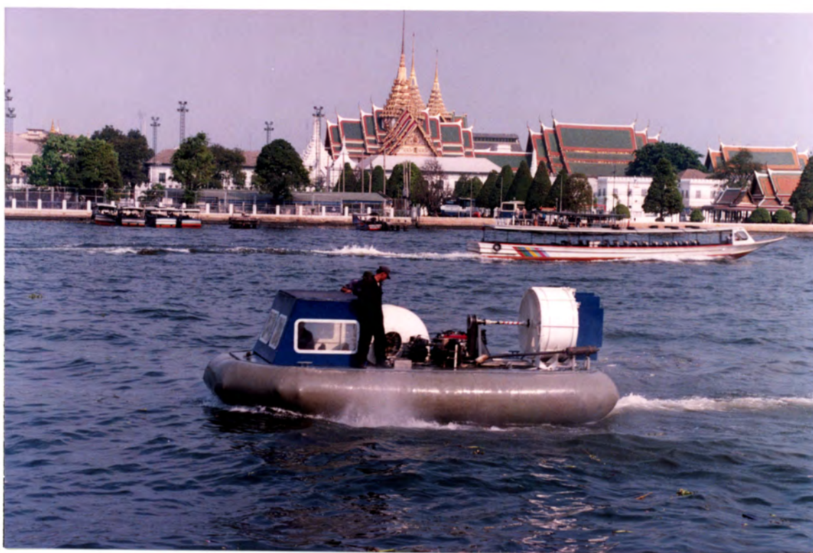
รูปที่ 4.8 การทดลองเล่นในน้ำของเรือแบบ Separated Lift/Thrust (เรือดำที่ 3)
