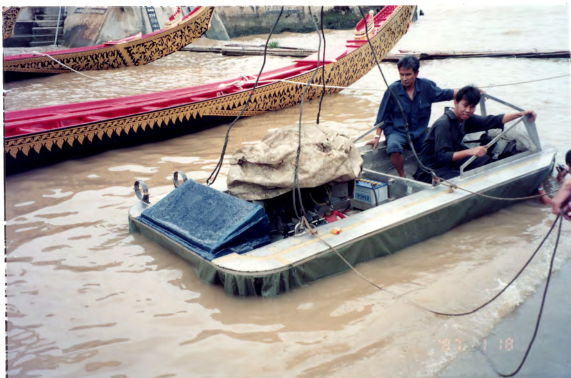
รูปที่ 4.3 การทดลองการลอยตัวหน้าท่าของเรือแบบ Combined Lift/Thrust (เรือลำที่ 1)
