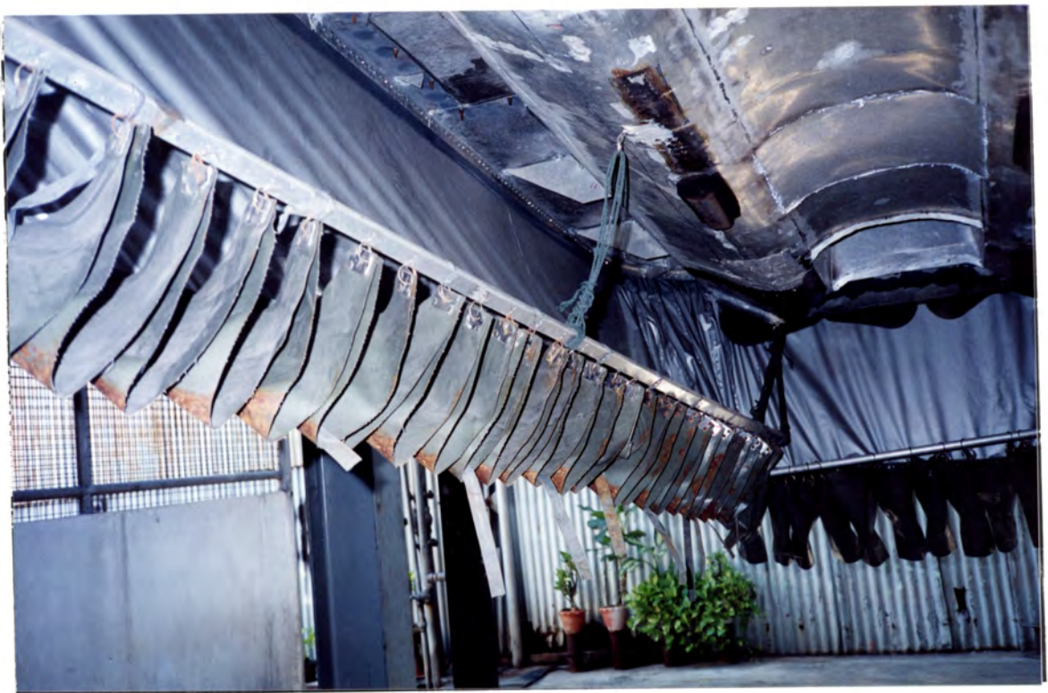
รูปที่ 3.2 การติดตั้ง Loop และ Segment ของเรือแบบ Combined Lift/Thrust
