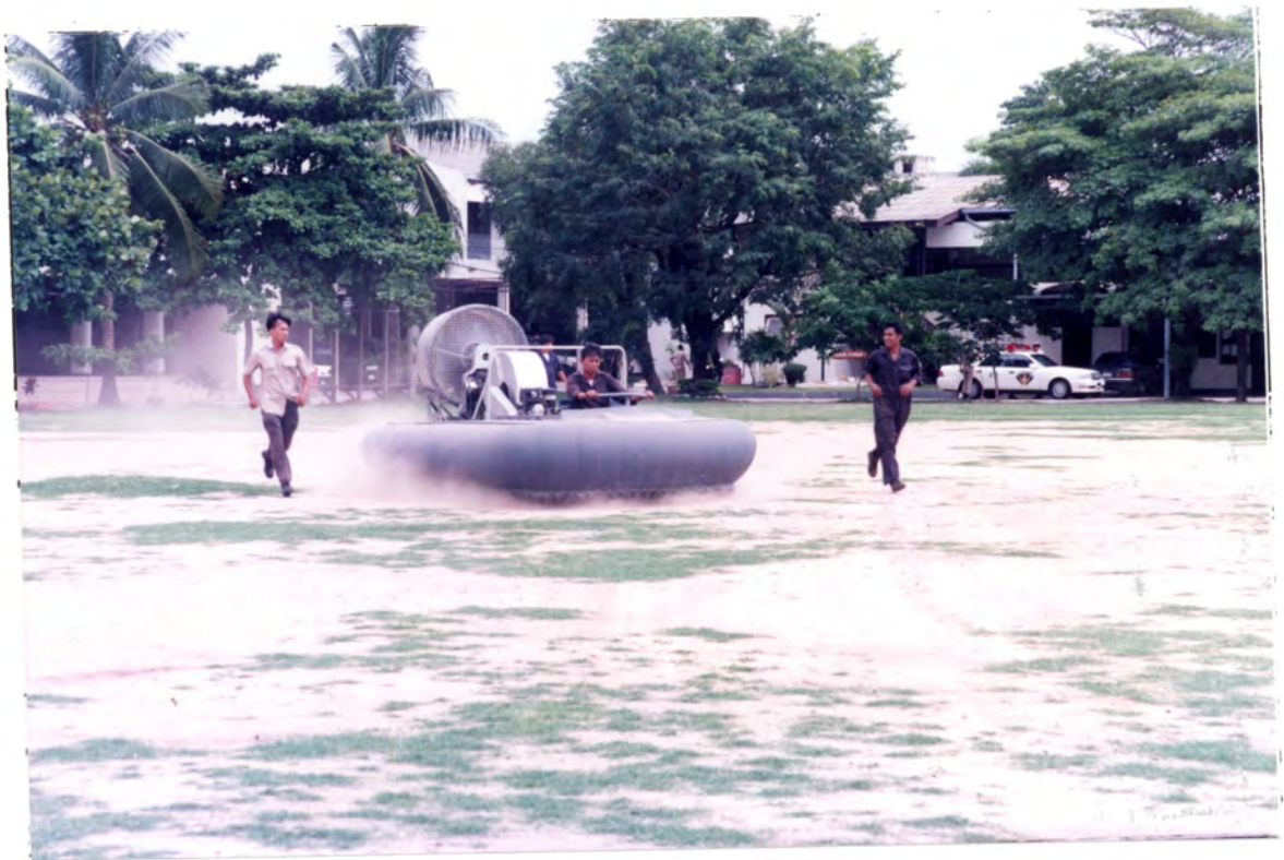
รูปที่ 4.4 การทดลองในสนามของเรือแบบ Separated Lift/Thrust (เรือลำที่ 2)
